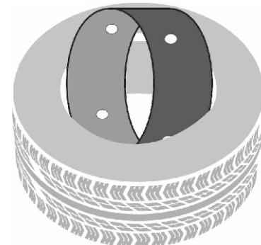
С небольшим усилием развернуть распорную втулку внутри посадочного отверстия за 90°, чтобы плоскость распорной втулки совпала с плоскостью шины
