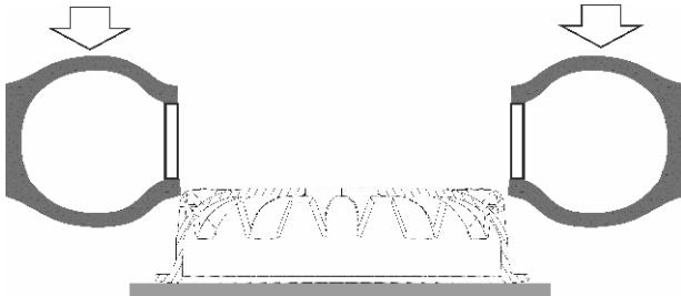
Положить шину с распорной втулкой на внутренний полудиск сверху нижний борт шины на обод внутреннего полудиска
